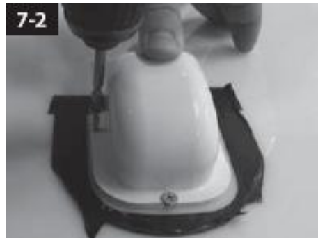
7-2 Na střechu auta upevněte držák na kabely, použijte 3 šrouby M4x20
