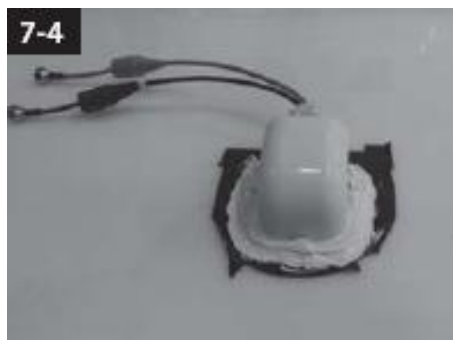
7-4 Zasuňte regulační kabel i kabel od antény
